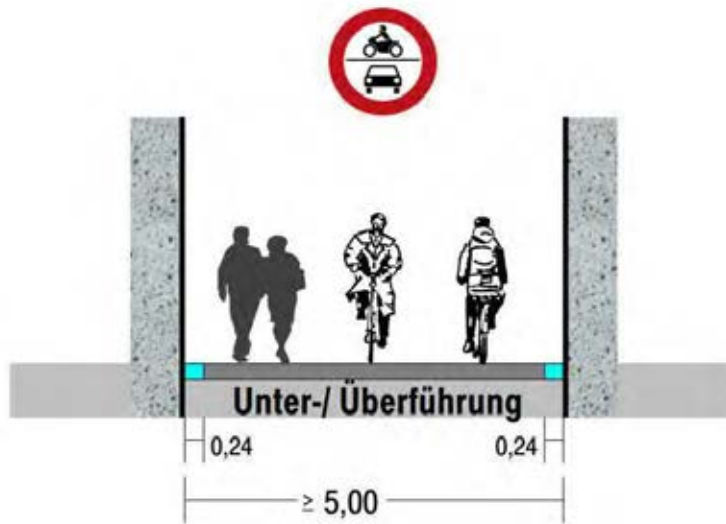
Musterquerschnitt A1S: Unterführung / Überführung
